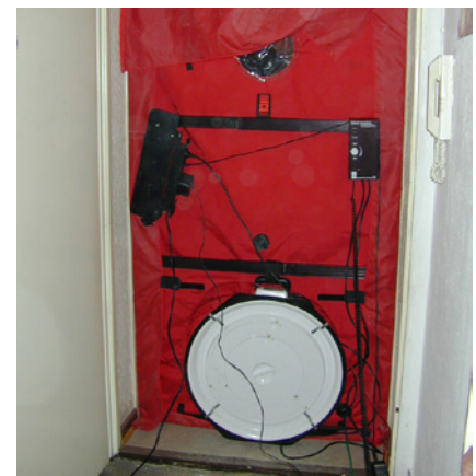
Hier wird gerade ein Drucktest vorgenommen. Ein Spannrahmen klemmt die Messeinrichtung im Türschwelle fest.
